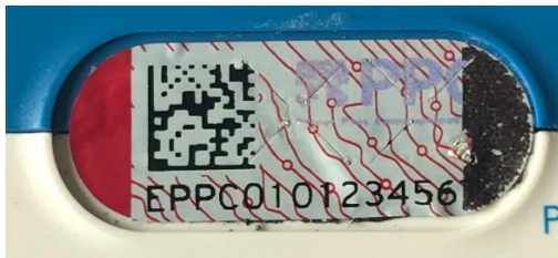
Abbildung 6: Zustände des Siegels des Smart Meter Gateways
